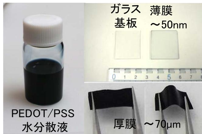
図1 PEDOT/PSS 水分散液と基板上薄膜と厚膜
